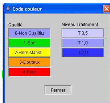
Figure 2 : Niveau de traitement et de qualité des données lors de la procédure de contrôle (capture d'écran de l'outil de contrôle qualité)
