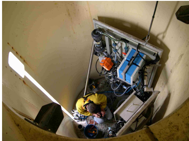
Figure 2 : La station de mesure en test en atelier, puis dans le tube sur site
