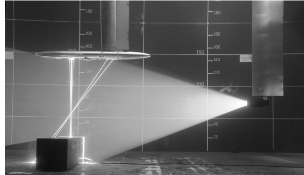
Vue du bassin à houle et courant (à gauche) et illustration de mesures LDV 3C et PIV 2D de l'écoulement autour d'une variation bathymétrique (à droite)
