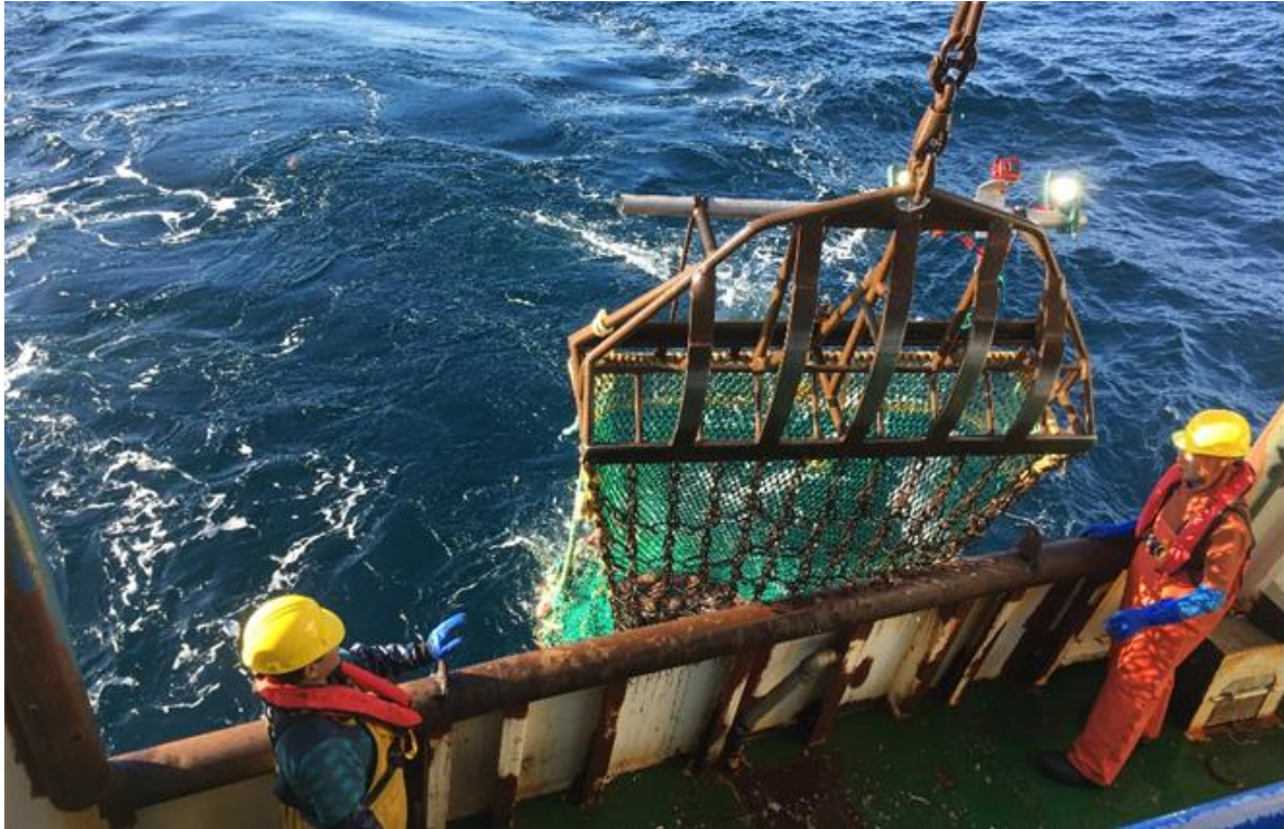
Figure 11.5.2.13.3: Drague à concombre modifiée.
