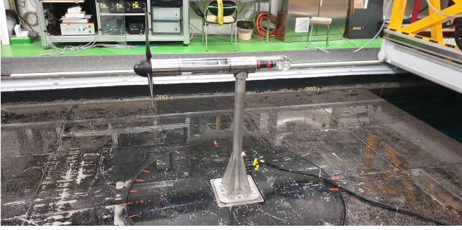
(a) Modèle réduit d'hydrolienne en préparation au bassin à houle et courant de l'IFREMER.
